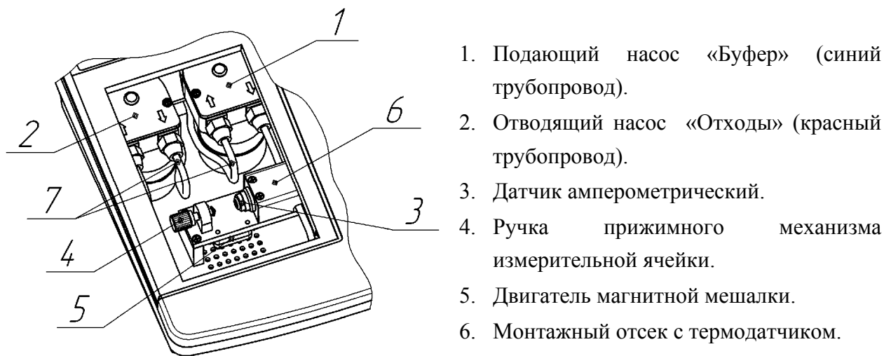
Рис.10. Вид рабочей секции анализатора (со снятой ячейкой).
