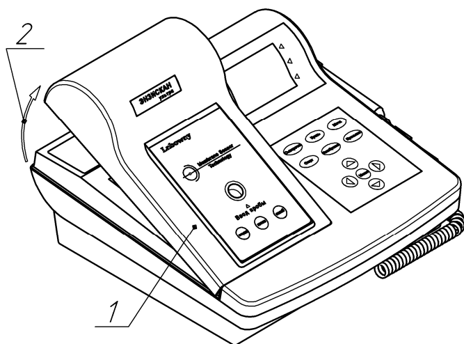
Рис.7. Вид анализатора при снятии крышки рабочей секции.
