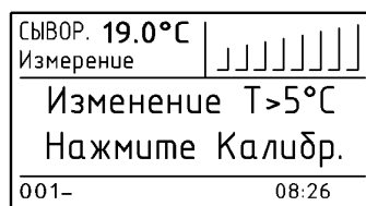
Рис.15, вид 1. Температура системы изменилась более 5 °C. Произведите калибровку.
