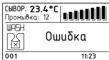
Рис.15, вид 5. Измерение за верхней границей диапазона, выше 30 ммоль/л.
