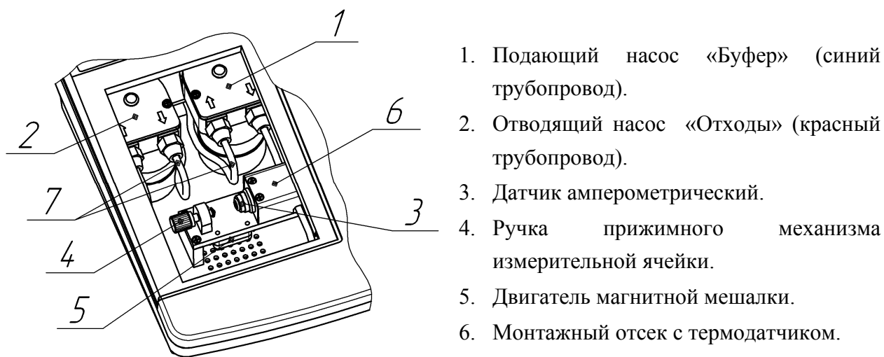
Рис.10. Вид рабочей секции анализатора (со снятой ячейкой).
